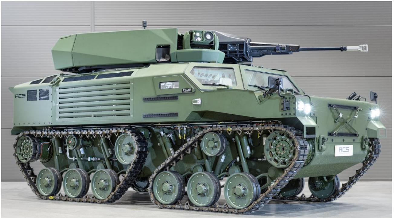
Kern im TS Antrieb war ein hybrides Antriebskonzept. Typischerweise haben Kettenfahrzeuge ein Überlagerungslenkgetriebe. Schwerpunkt dieser Getriebe sind Fahrzeuge mit vielen Tonnen Gewicht, wie ein Schützenpanzer PUMA. Für ein kleines Kettenfahrzeug mit ca. 5t zulässigem Gesamtgewicht (zGG) kam ein solches Getriebe aus Zeit- und Budgetgründen nicht in Frage.
