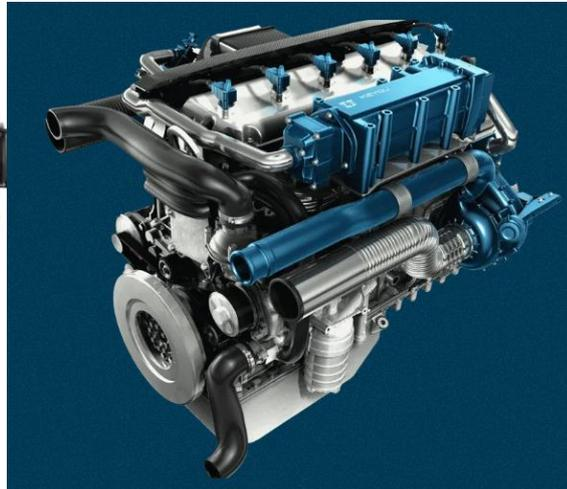
Abbildung 11: Methanol/Wasserstoff Verbrennungsmotor von der Obrist Group/Keyou
